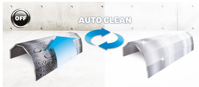
Wenn Sie das Samsung Wind Free ausschalten wird automatisch die Auto-Clean Funktion aktiviert. Diese startet den Lüfter und entfernt Staub und Feuchtigkeit von dem Wärmetauscher des Gerätes. So bleibt das Gerät sauber und trocken, und verhindert das Wachstum von Bakterien und Schimmel.
